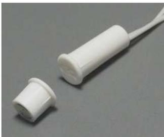
Извещатель охранный точечный магнитоконтактный ИО 102-15/2 для пластиковых окон и дверей, предназначен для блокировки дверных и оконных проёмов, а также блокировки других конструктивных элементов зданий и сооружений на открывание или смещение, посредством замыкания и размыкания электрической цепи.
